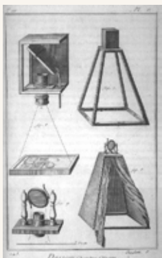
Esquema de una cámara oscura de 1772 aproximadamente.
